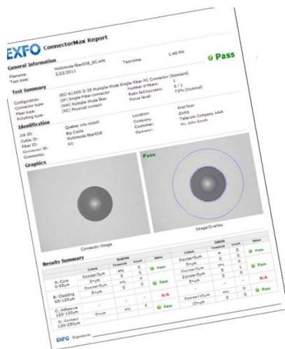
El tipo de inspecciones anteriormente descrito da lugar a la emisión de un informe similar al adjunto, que puede ser incluido, en función del equipo de medida utilizado, en el bloque general de calificación de la fibra estudiada.
