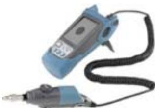
[Conjuntos microscopio-display](#) : Permiten la inspección, con visualización indirecta, sin posibles daños a la vista, tanto de conectores macho como hembra. En algunos casos permiten el registro de imágenes para su comparación posterior, sin datos de certificación.
