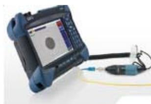
[Sondas microscopio conectadas a equipos de medida](#) : Proporcionan un sistema completo que permite la visualización indirecta, comparación y caracterización, conjunta con la de la red o por separado de los conectores ópticos. Estableciendo un informe pasa/no pasa con respecto al estándar.
